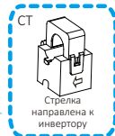
Датчик тока надевают на фазный провод сети. Стрелка направлена к инвертору
